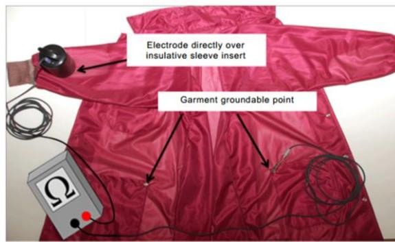
**R<sub>gp</sub>: rezistență punct cu punct de împământare**
